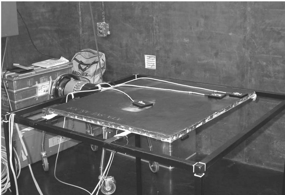
**Figura 4.** Sensores de medición de radiación.
