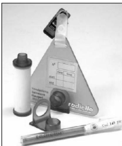
**Figura 2.** Tubos Radiello para la absorción de gases.
