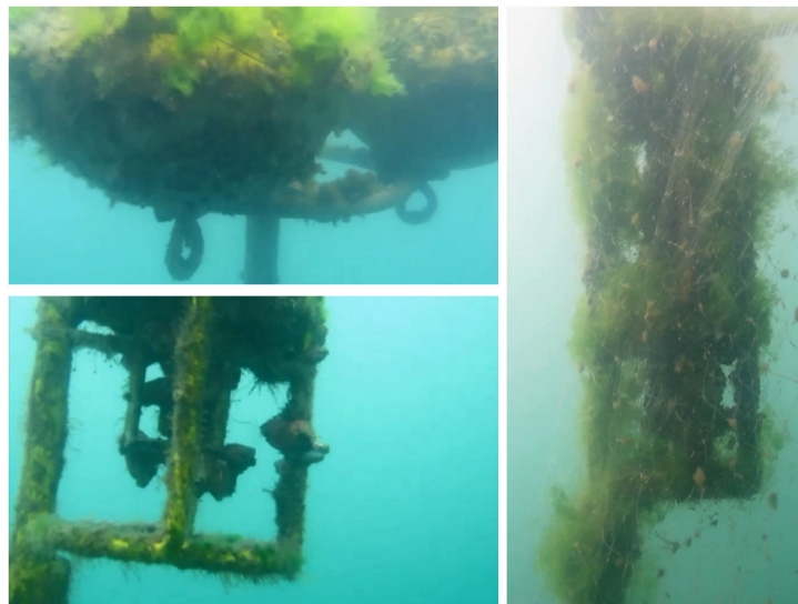
Figura 1.6. Incrustação na estrutura e nos instrumentos do fundeio. Fotos: Rodolfo Jasão Soares Dias.
