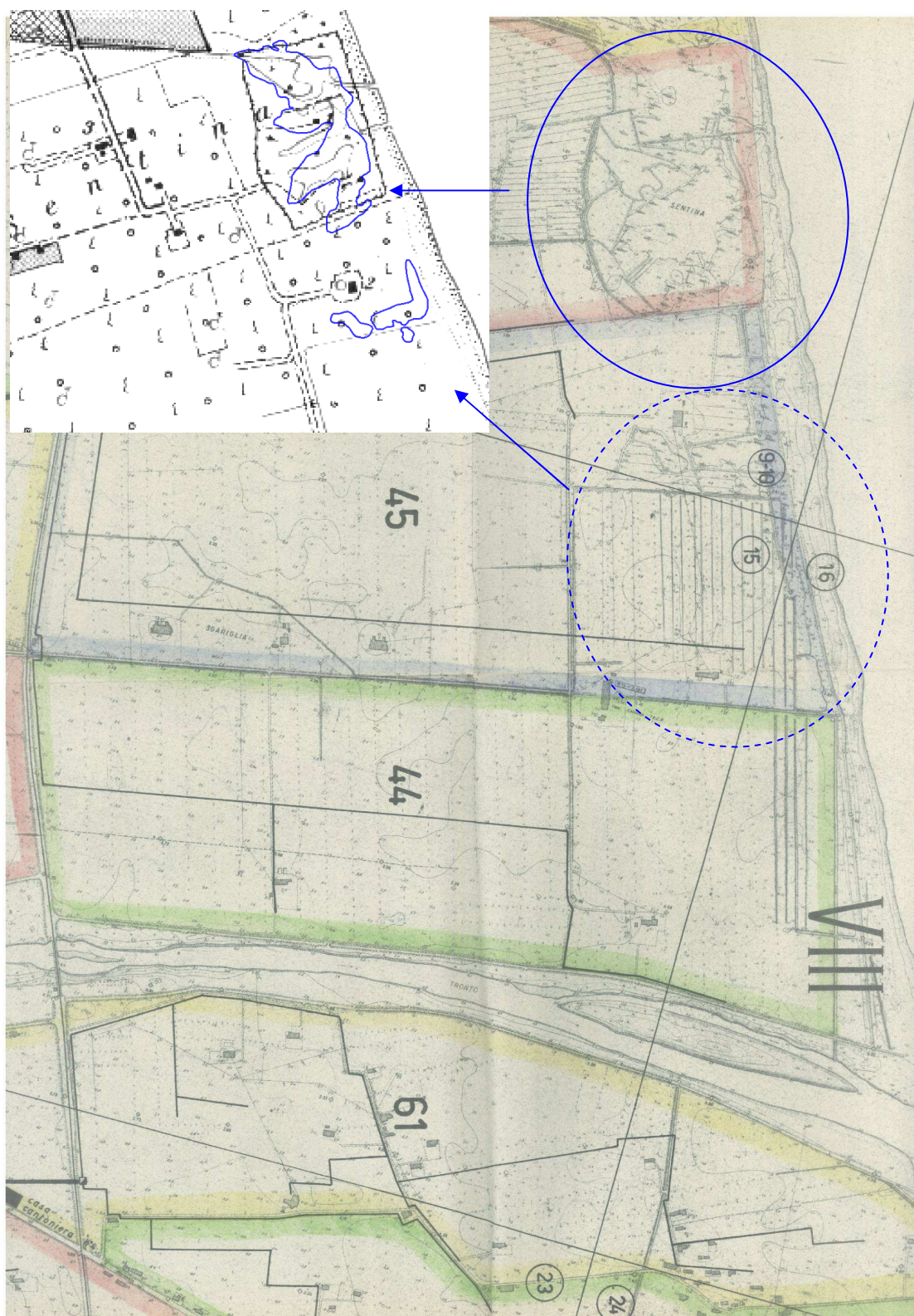
Fig. 2.3g – Cartografia 1954, in blu sono evidenziate le aree storicamente soggette ad allagamento. La linea continua indica la zona umida alla foce del fosso collettore e quella tratteggiata aree maggiormente statiche. Nell'ingrandimento, zone allagate riportate su stralcio Tavoleta I.G.M.I.
