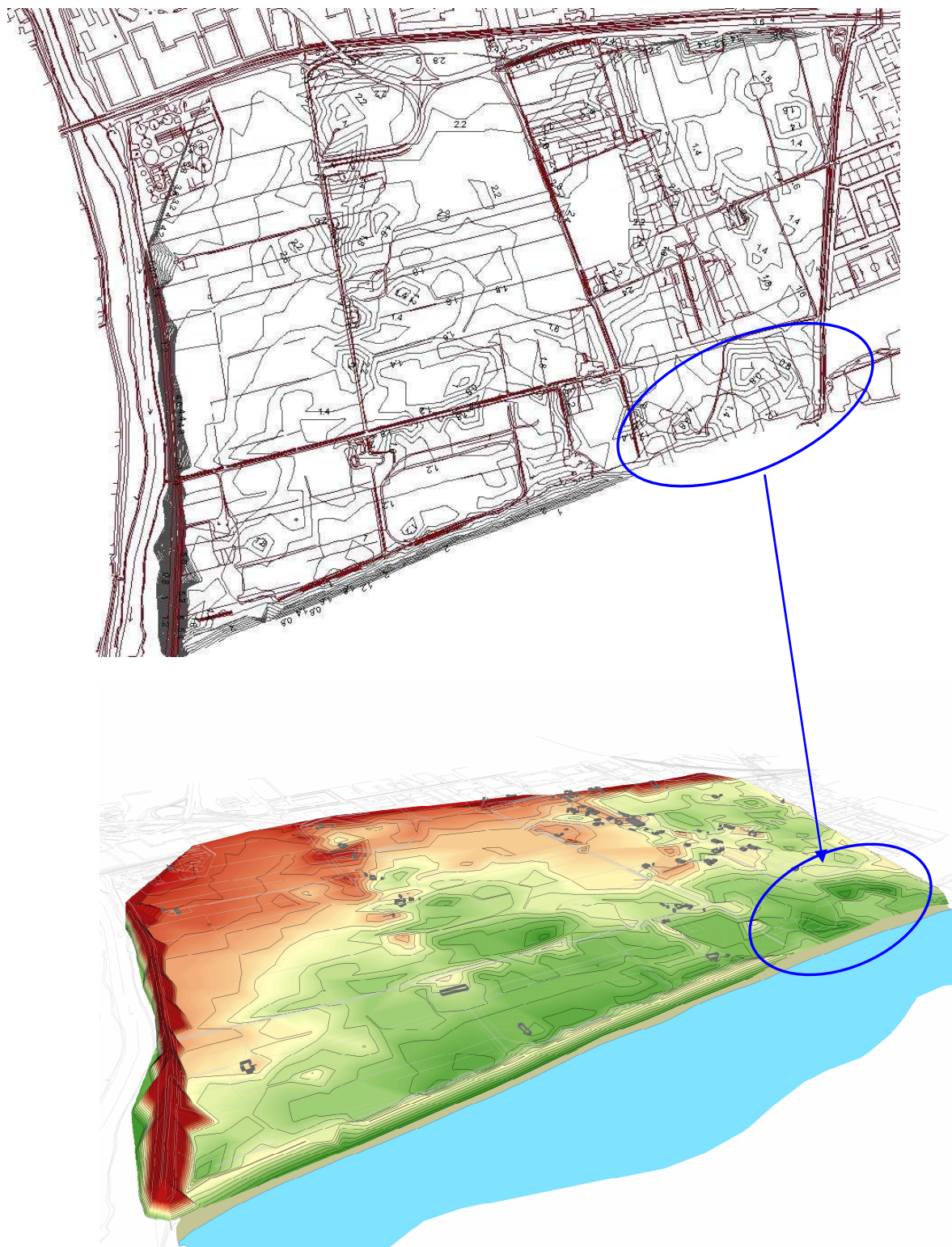
Fig. 2.3h – Assetto plano-altimetrico del 2007 (in alto) e relativo modello digitale (in basso) ricavati dall'aerofotogrammetrico 2007. In blu sono evidenziate le aree maggiormente vocate all'allagamento.
