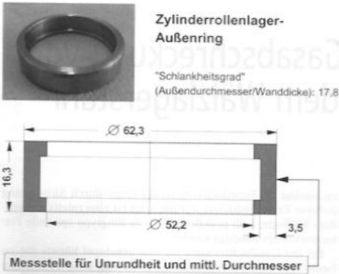
Bild 2. Verwendete Ringtype, Abmessungen, Messstelle Fig. 2. Applied ring type, dimensions, measuring location
