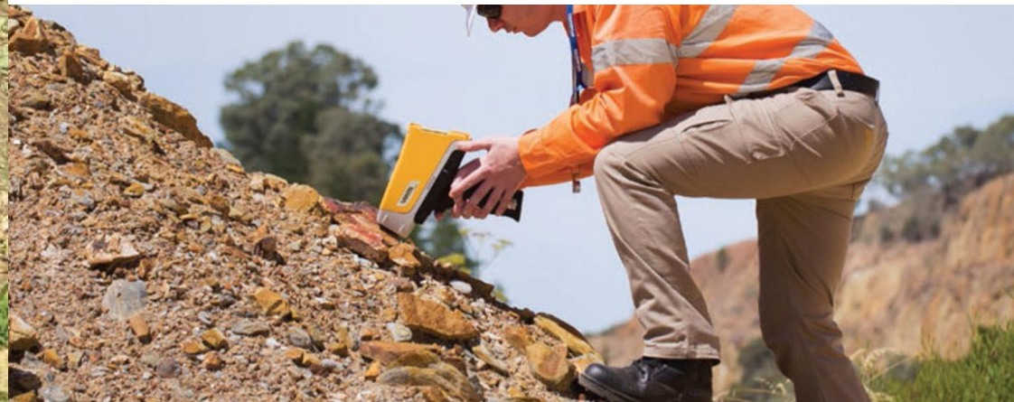
Portable XRF (pXRF) Lemière (2018)
