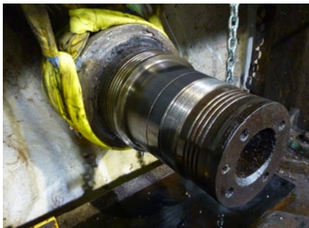
Vorbereitete Welle für Lagereinbau
