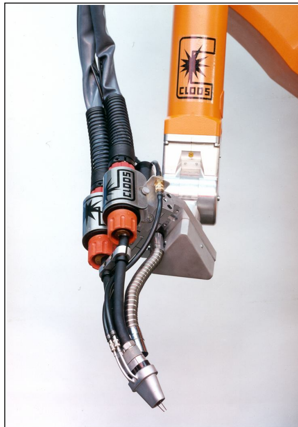
Bild 24: Brennersystem mit Drahtanordnung zum Tandem-Schutzgasschweißen
