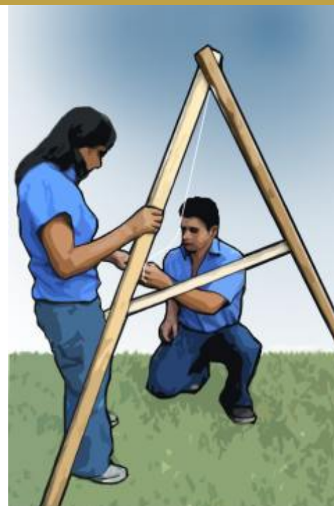
Fig. 28. Construcción del nivel "A".
