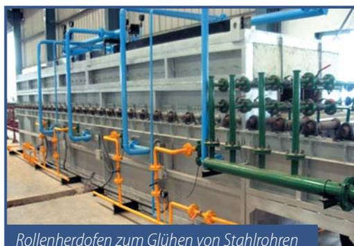
*Rollenherdöfen zum Glühen von Stahlrohren*
