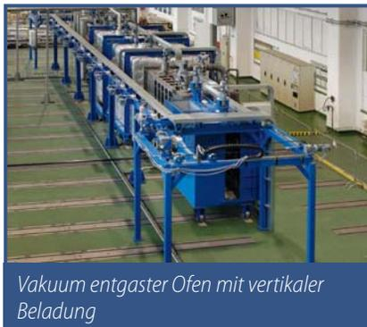
*Vakuum entgaster Ofen mit vertikaler Beladung*
