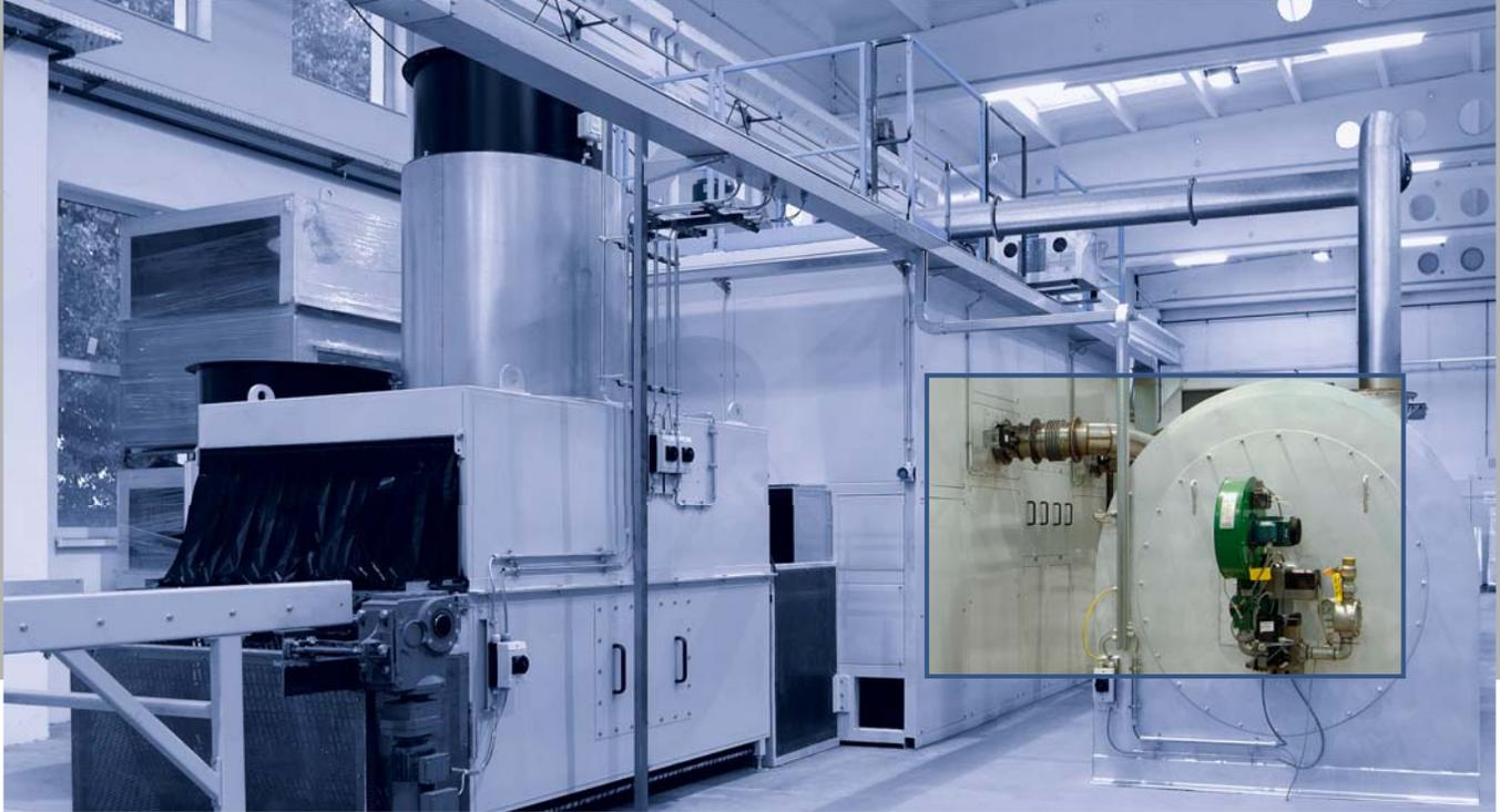
Lötverfahren von Aluminium in kontrollierten Atmosphären (CAB), bei denen nicht korrosives Flussmittel verwendet wird, werden bevorzugt zur Herstellung von Aluminiumwärmetauschern eingesetzt. Seit unserem Einstieg in diese Technologie im Jahre 1983, haben wir die Entwicklung einer Durchlauf-Lötöfenanlage vorangetrieben. Durch unsere langjährige Erfahrung konnten wir auch zahlreiche Innovationen vorantreiben:
