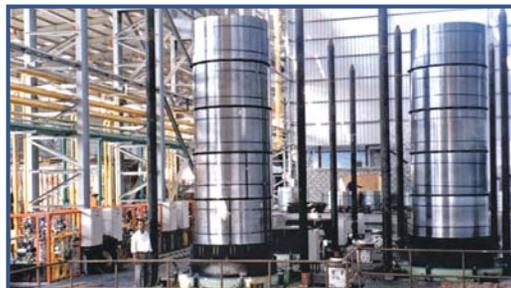
*Blanke Charge nach Glühen in Haubenöfen unter Einsatz von Wasserstoff als Schutzatmosphäre*
