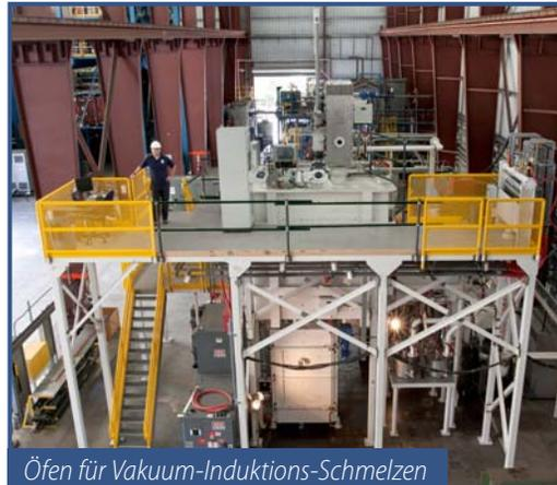
Öfen für Vakuump-Induktions-Schmelzen
