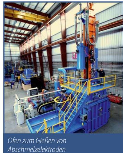
*Ofen zum Gießen von Abschmelzelektroden*
