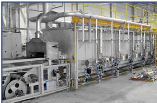
*Bandofenlinie zum Karbonitrieren, Härten und Anlassen von kleinen Hydraulikkomponenten*
