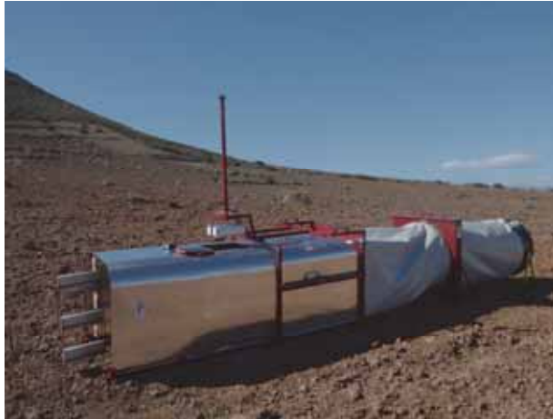
Foto 1. Túnel de viento en el que se aprecia el láser-scan antes de ser introducido para hacer la lectura y los colectores de partículas.
