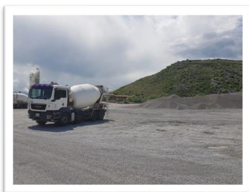
Slika broj 6. Mikser za prevoz betona
