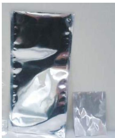
Figura 5.25. Empaque barrera media (polipropileno bio-orientado metalizado) para el almacenamiento de la pulpa microencapsulada de asaí.
