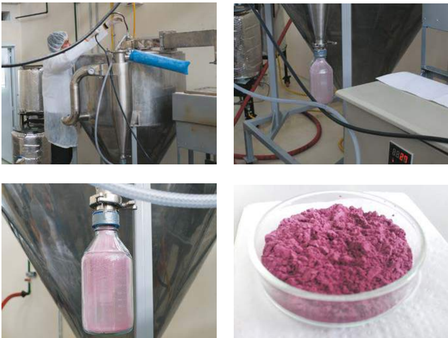
Figura 5.24. Proceso de microencapsulación de pulpa de asaí.
