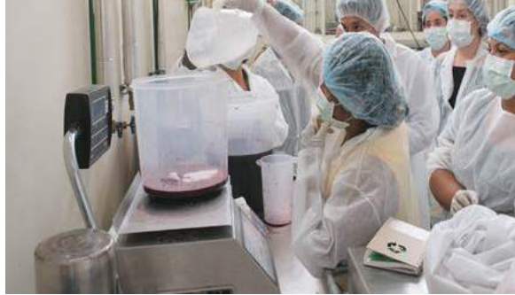
Figura 5.23. Proceso de mezclado de la pulpa de asaí con maltodextrina.
