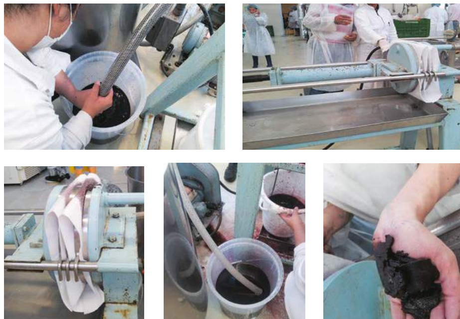
Figura 5.22. Proceso de filtración de la pulpa de asaí usada como materia prima para microencapsulación.
