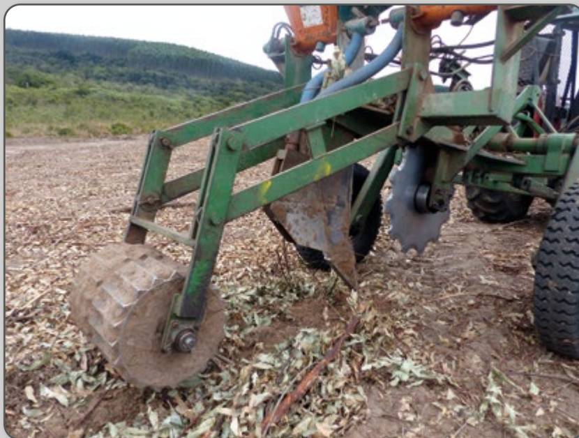
Figura 88 – Implemento florestal (subsolador + grade + disco).
