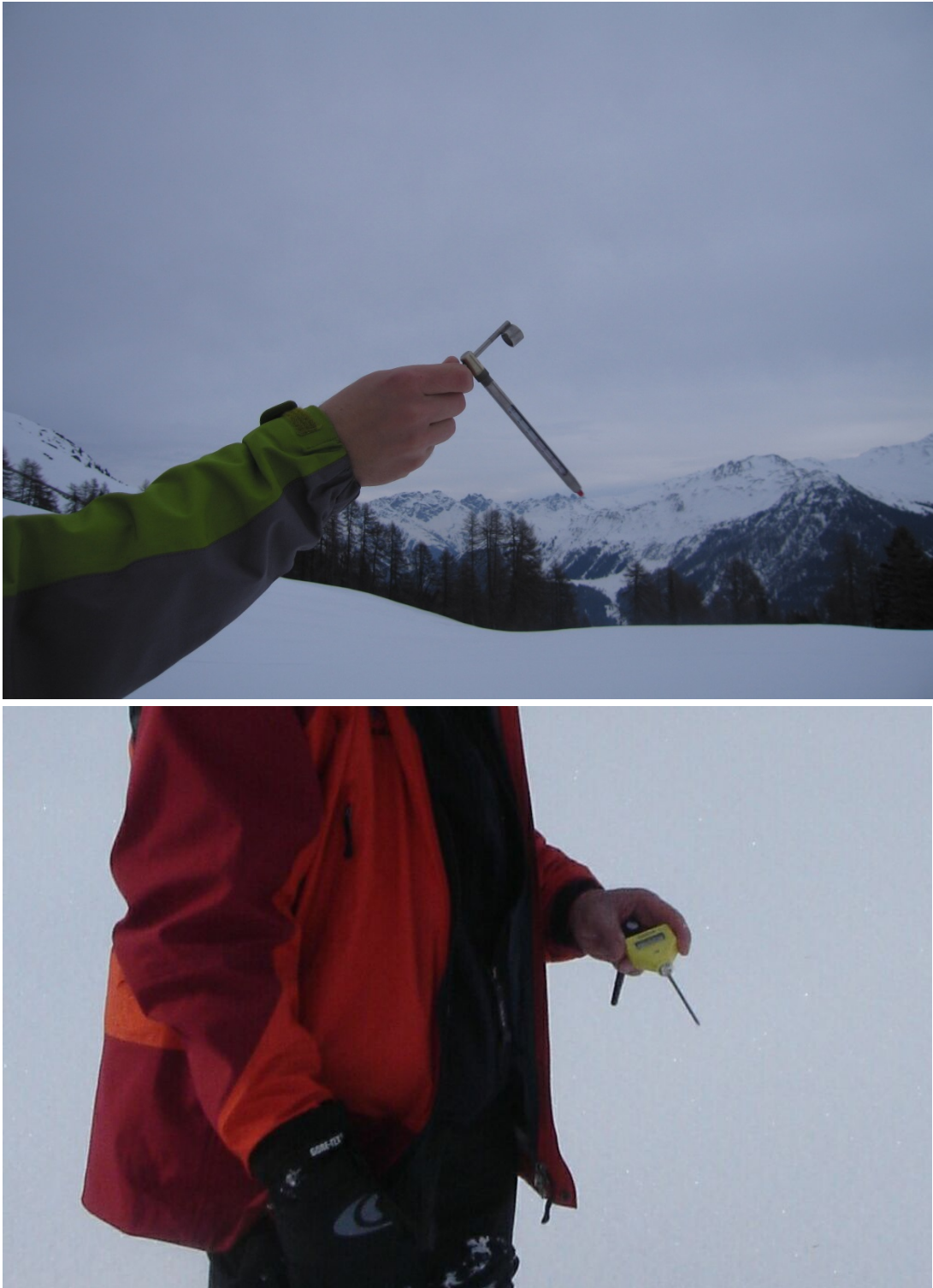
Fig. 5: Per misurare la temperatura dell'aria, il termometro ad alcool (in alto) viene "centrifugato". Il termometro digitale (in basso) è meno indicato per misurare la temperatura dell'aria. Deve essere ventilato agitandolo costantemente da una parte all'altra. La misura avviene sempre all'ombra (prodotta dal proprio corpo).
