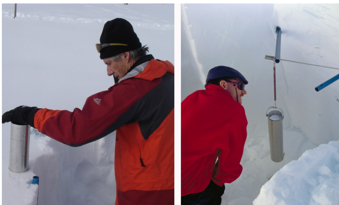
Fig. 3: Misura dell'equivalente in acqua: se possibile la bilancia a molla deve essere appesa a un oggetto fisso (ad es. sonda penetrometrica o bastoncino da sci infilati nella neve). Accertarsi che la sonda per misurare l'equivalente in acqua sia liberamente sospesa.
