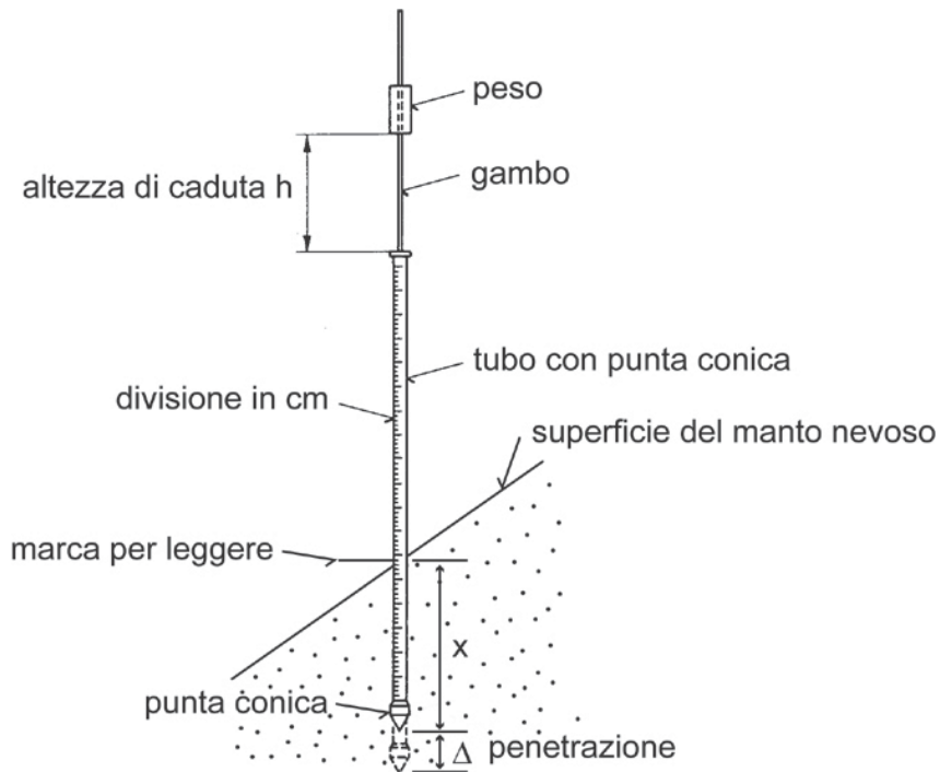
Fig. 12: Sonda penetrometrica per il rilevamento di un profilo su terreno pianeggiante.
