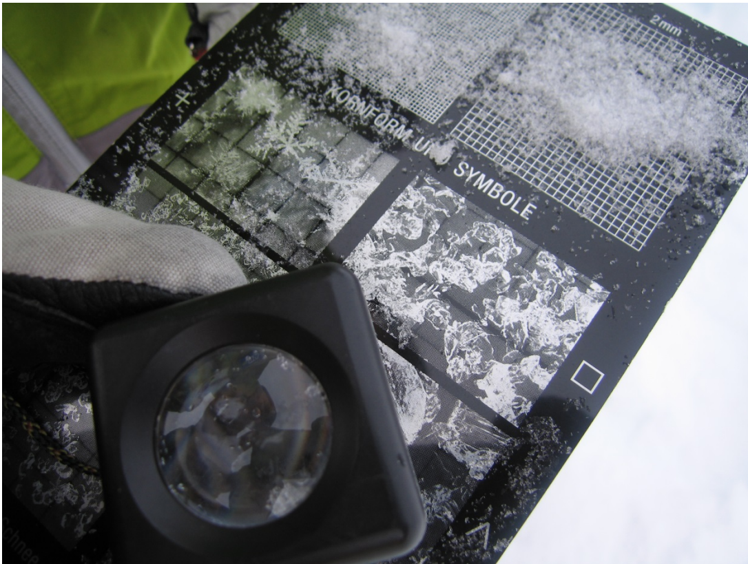
Fig. 13: Griglia e lente d'ingrandimento per determinare le forme e le dimensioni dei grani.
