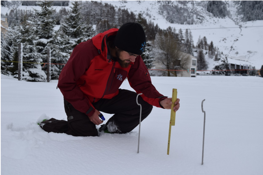
Fig. 2: Misura della quantità di neve fresca sull'apposita tavola. Le due aste che sporgono dal manto nevoso indicano dove è situata la tavola. Dopo aver misurato la quantità di neve fresca al mattino, la tavola viene liberata dalla neve e quindi nuovamente appoggiata sulla superficie del manto nevoso. In caso di trasmissione dei dati a mezzogiorno, la tavola viene lasciata nel manto nevoso.
