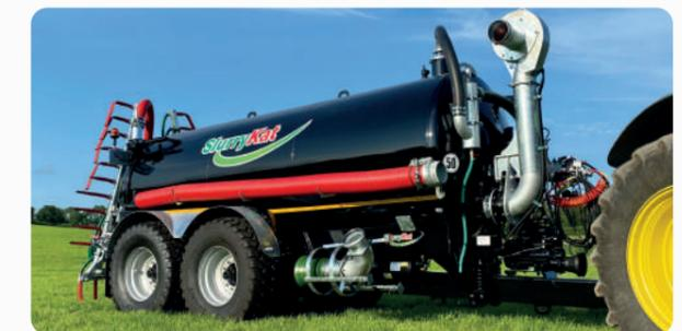
4000G/18 m<sup>3</sup>, Hinterachsenlenkung, automatische Befüllung mit 8 Zoll mit Turbopumpe und Schleppschlauch
