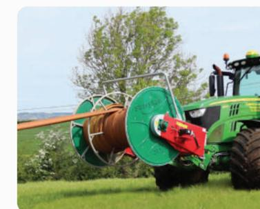
Aufroller an der Vorderseite beim Aufwickeln eines 1000-m-Schlauchs
