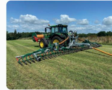
12-m-Premium Plus™-Schleppschuh mit Schlauchauflöcher an der Vorderseite
