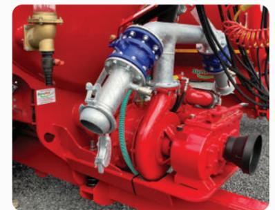
DODA®-L35/Battioni- Evo-Doppelpumpensatz fördert mit 12 bar / 250 m<sup>3</sup> pro Stunde und speist ein Schlauchsystem
