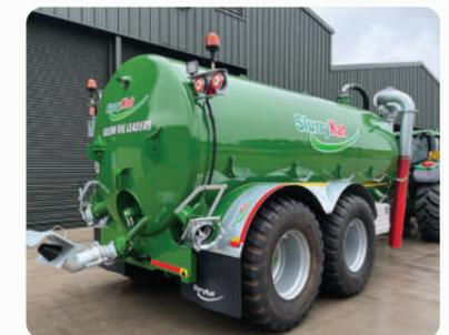
3500G/16 m<sup>3</sup> Premium Plus™-Güllewagen mit Tiefenbefüllung mit 8-Zoll-Ladearm mit integrierter Turbopumpe und internem Sand/Sediment-Mischsystem
