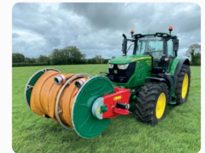
An der Vorderseite montierter Schlauchaufroller mit SlurryKat-Kupplungen
