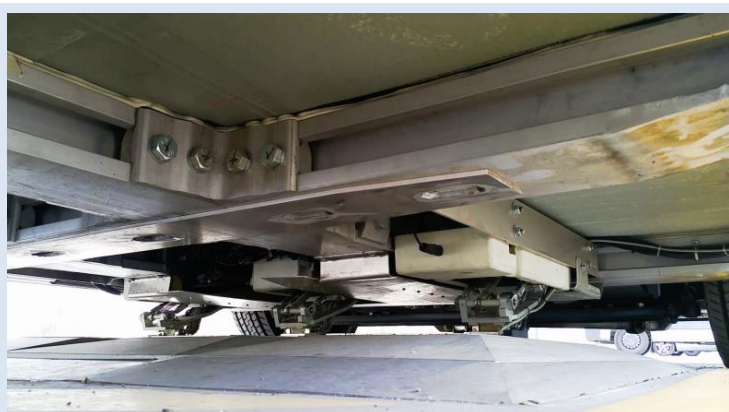
Obr. 24 Standardizované spodní čtyřpólové kontaktní dobíjení © Alstom
