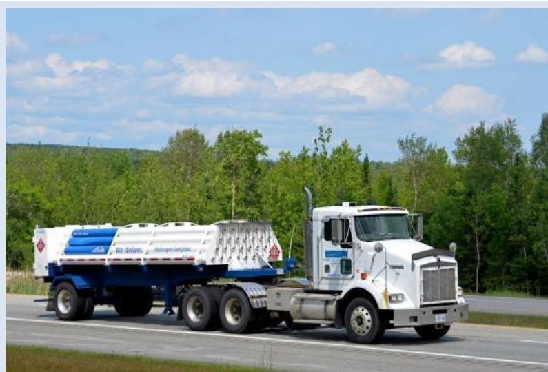
Obr. 28 Doprava stlačeného vodíku v trubkových nádržích na návěsu
