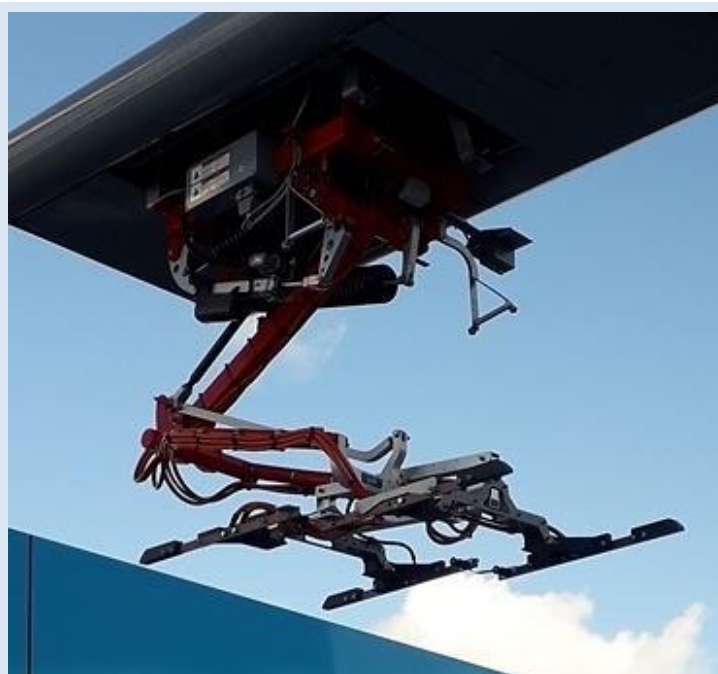
Obr. 19 Invertovaný pantograf panto-down (OppCharge)
