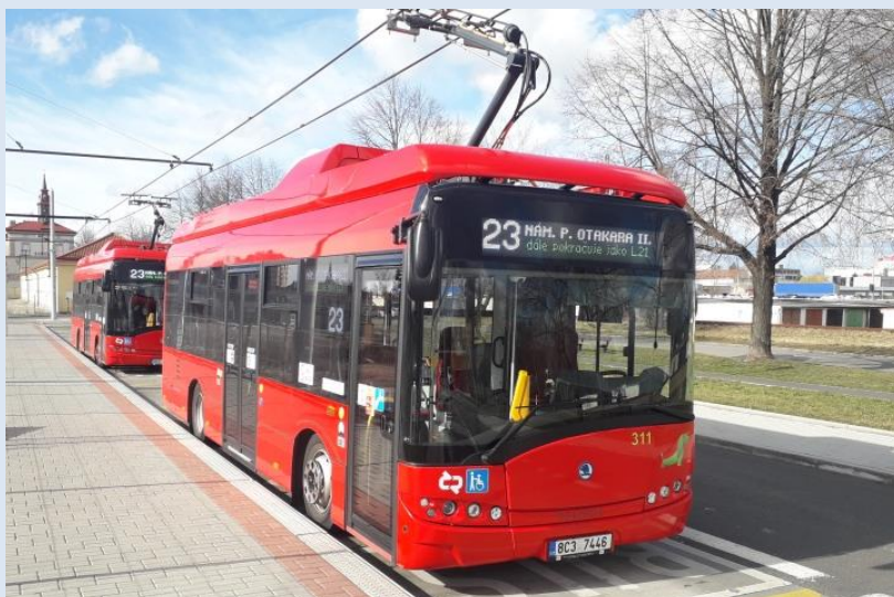
Obr. 22 Dvoupólové dobíjení elektrických midibusů v Č. Budějovicích
