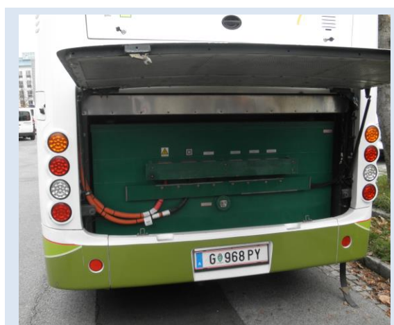
Obr. 15 Superkapacitorová jednotka v ochranném kontejneru (e-bus Chariot)
