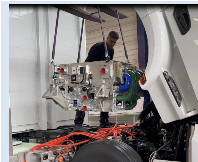
Obr. 17 Příklad palivočlánkové jednotky pro těžká elektrická vozidla
