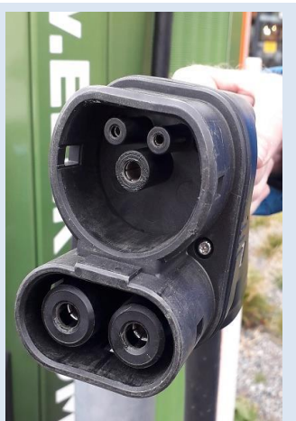
Obr. 18 Standardizovaná zásuvka CCS/Combo 2 © Smartcityvpraxi.cz
