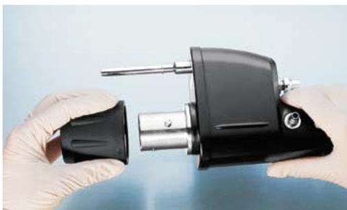
Retire todas las válvulas, la tapa del extremo distal (si está presente) y todos los demás componentes desmontables y limpiarlos por separado.
