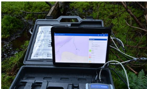
Mobilní zařízení pro průzkum v terénu, které společně využívají studenti (tablet s GIS kartou O sloužící zjišťováním geografických údajů, přístroje pro měření základních chemických hodnot) (Jiří Šmída, Technická univerzita v Liberci)
