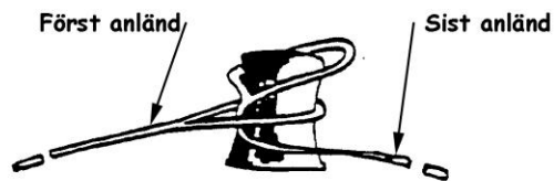
Förtöjning av två förtöjningstrossar
