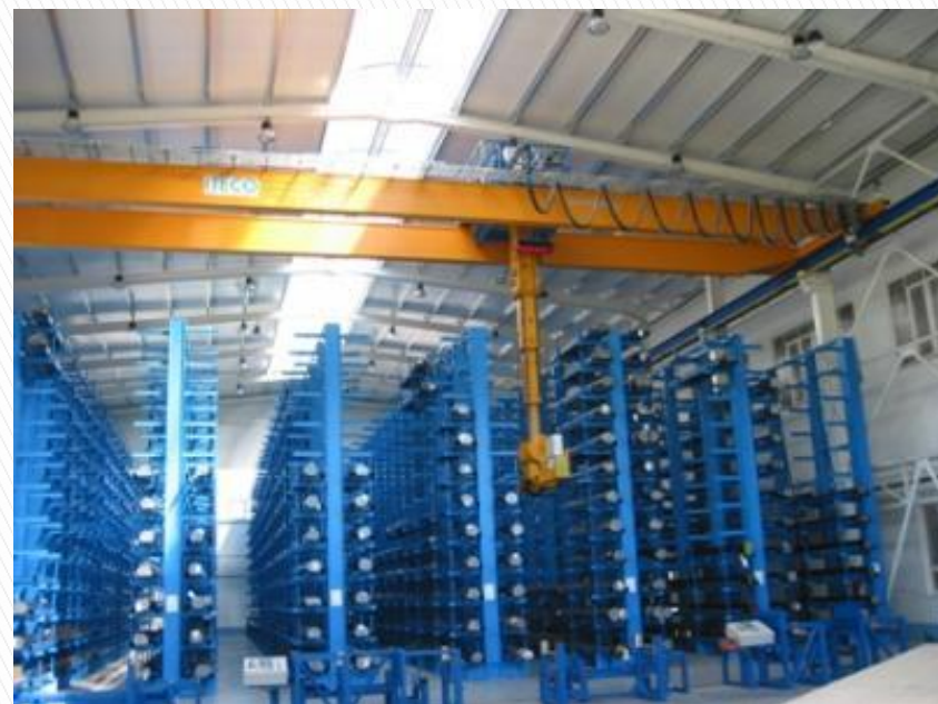
Obr. 11: příklad speciálního stohovacího jeřábu [8]
