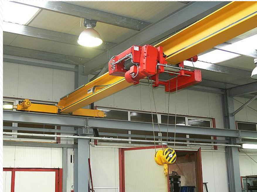
Obr. 9: Příklad jednonosíkového jeřábu [11]
