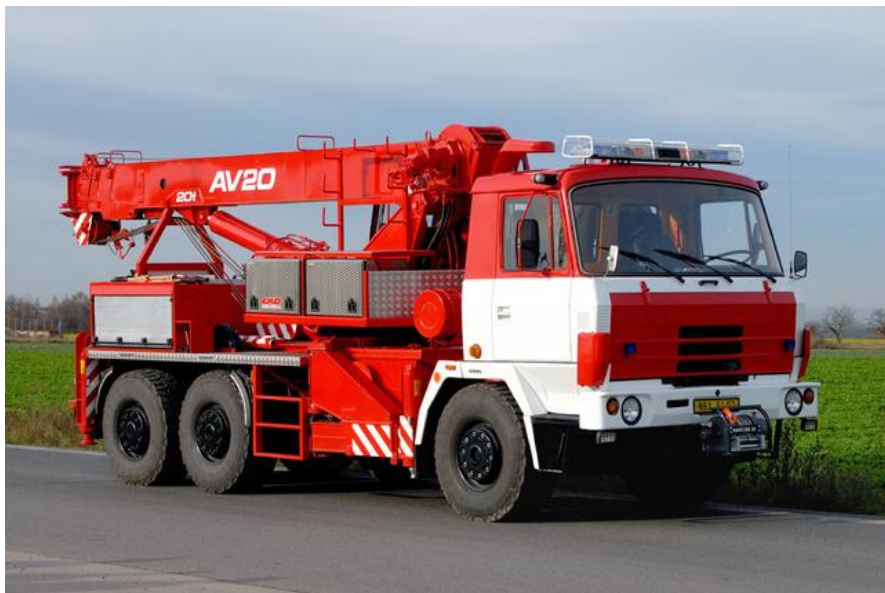
Obr. 19: Mobilní jeřáb ČKD AV20 (vyprošťovací) na podvozku TATRA 6x6 určená pro záchranné složky [4]
