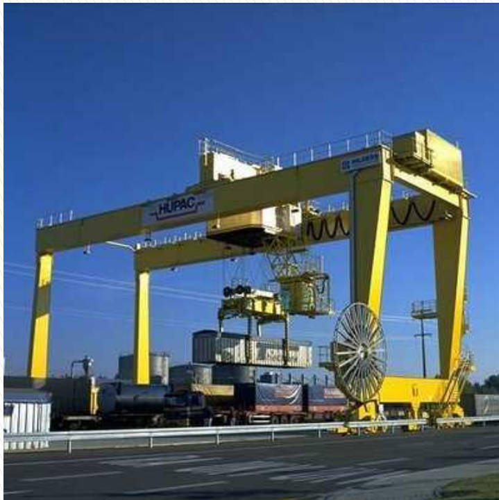
Obr. 3: Příklad portálového jeřábu [7]
