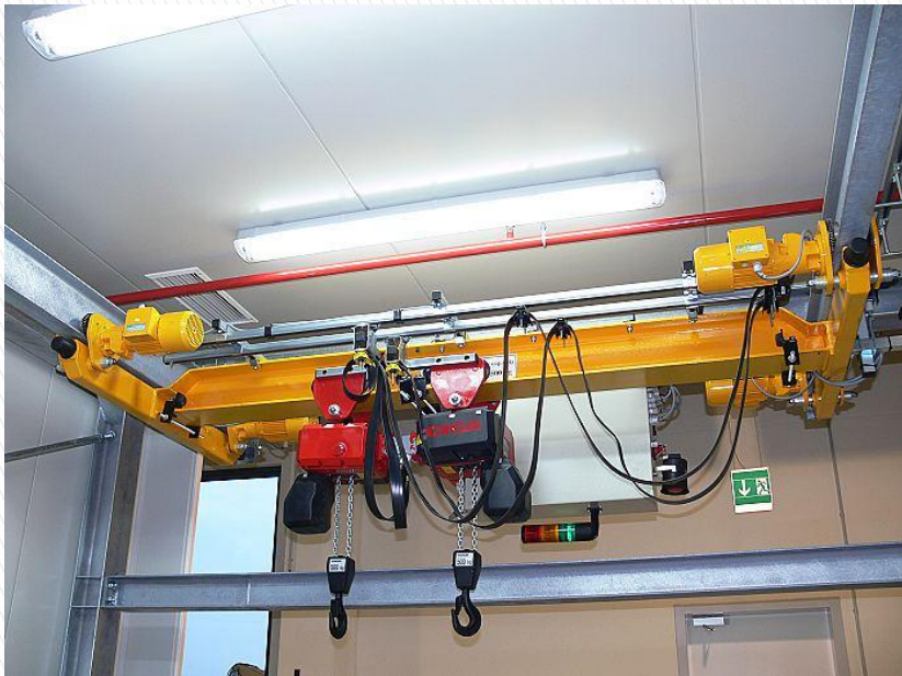
Obr. 8: Příklad podvěsného jeřábu [9]
