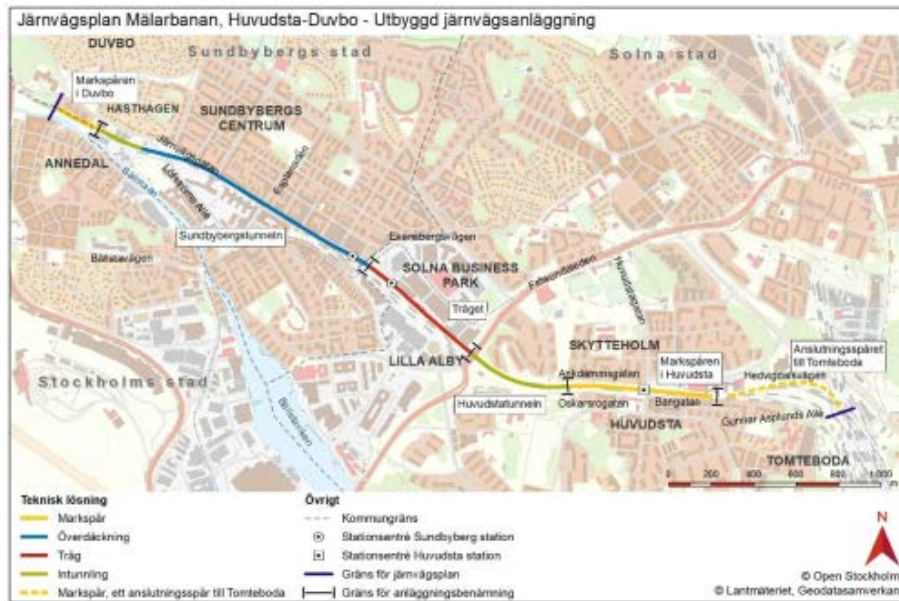
Figur 34. Sträckning Mäljarbanan Huvudsta-Duvbo (från järnvägsplanen). Planerad ny bebyggelse inom detaljplanen kommer att ske framför allt längsmed den gröna linjen och till mindre del längs den röda linjen.
