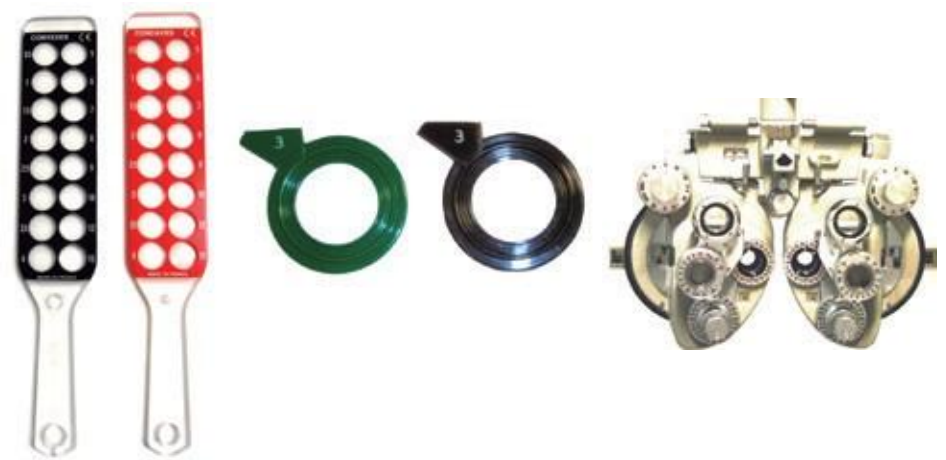
Figura 3.4 - À esquerda, as régua de esquiopia (são compostas por lentes convexas ou côncavas de graduação crescente). Ao centro, as lentes isoladas e à direita, o foróptero.
