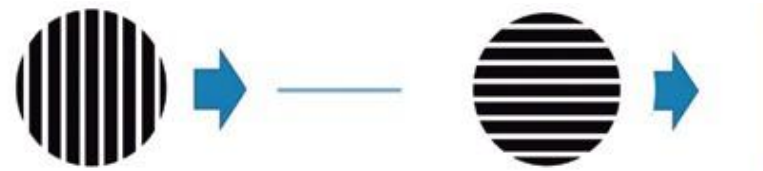
Figura 6.34- Através das estrias de Maddox um ponto de luz origina um imagem linear, perpendicular à disposição dos cilindros. Quando os cilindros estão dispostos na vertical o olho vê uma linha horizontal (à esquerda), quando estão na horizontal o olho vê uma luz vertical (à direita).
