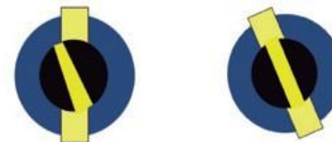
Figura 3.8- As sombras inclinadas na esquiopia. Ao rodar a manga do retinoscópio obtém-se o alinhamento do feixe com a sombra e a formato rectangular da sombra.
