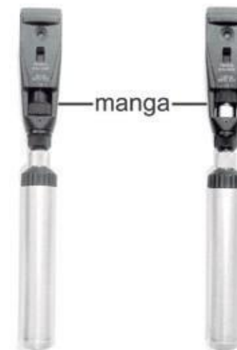
Figura 3.2- Retinoscópio de franja. À esquerda com a manga para baixo, à direita com a manga para cima.
