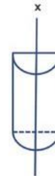
Figura 3.10- Lente cilíndrica com eixo x. Se a lente tiver uma gradação de +4,00D e o seu eixo x for colocado a 90°, o seu efeito óptico de +4,00D surge no eixo 180°. A 90° não existe qualquer efeito refractivo.
