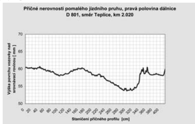
Obr. 1 Jednoduchý příčný výškový profil vyjetých kolejí v asfaltové vozovce
