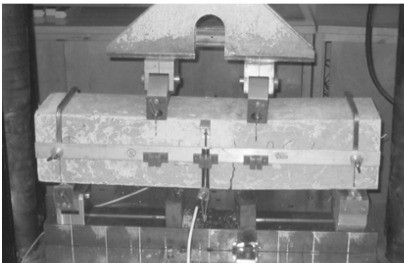
Obr. 1: Uspořádání čtyřbodové ohybové zkoušky dle (5)
