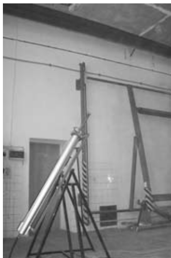
5. Zkouška odolnosti proti rázu – vystřel míče
