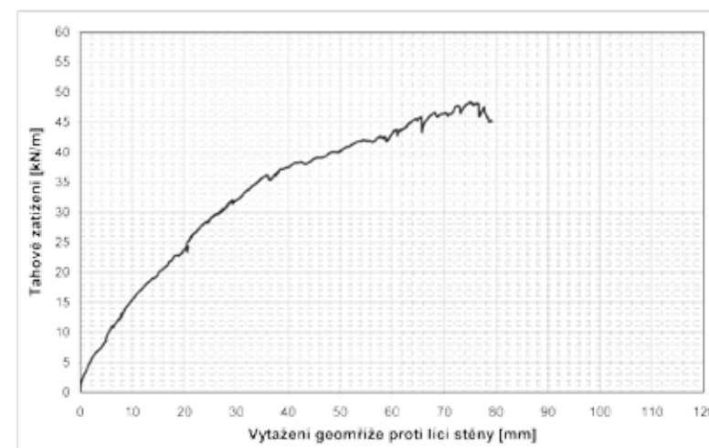
Obr. 4: Ukázka grafického záznamu závislosti tahového zatížení geomříží na jejich vytažení proti lici zkušební stěny
