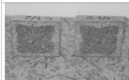
Obr. 4 Postup karbonatace na zlomech krychle C4 po třech měsících uložení v 95% CO 2
