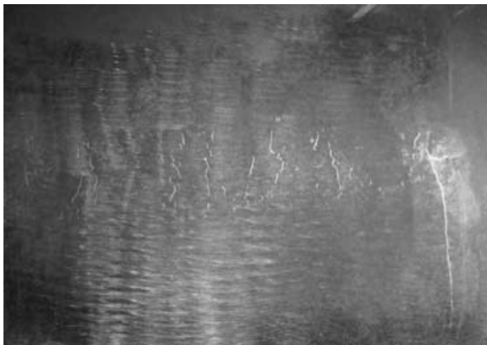
Obrázek 4 - Vada typu trhlin na povrchu plechu, zjištěná MT metodou, UV lampa
