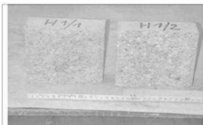
Obr. 3 Postup karbonatace na zlomech referenční krychle H1 před uložením do 95% CO 2
