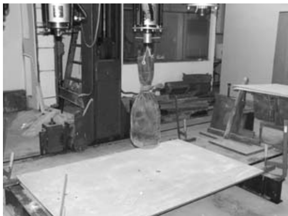
1. Zkouška odolnosti výplně zábradlí – těleso o hmotnosti 40 kg
