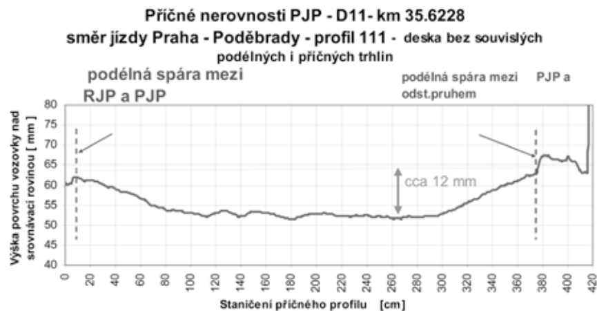
Obr. 5 Jednoduchý příčný výškový profil cementobetonové vozovky s vyznačením max. nerovnosti na jedné desce (zmenšena o chyby měření) v místě poruchy desky (průhyb způsobený objemovými změnami betonu v dolní části desky v důsledku ASR)
