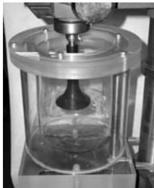
Obr. 5: Pracovní nádoba – vnější termostatická nádoba, vnitřní reakční nádoba
