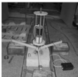
Obr. 4: Referenční měření na tuhé betonové podlaze
