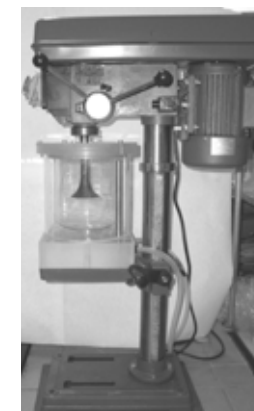
Obr. 2: Zařízení uvádějící disk do rotace – stolní vrtačka s volitelným rozsahem otáček
