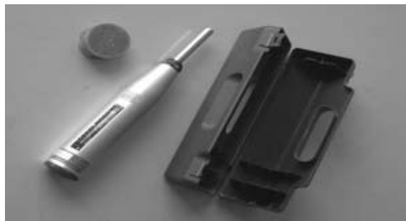
OBR. 1. Skúšobný prístroj SCHMIDT typu LB s ochranným puzdrom a ručným brúsny kotúčom [3]
