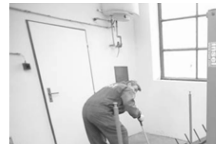
Foto 2: přestavení hydraulického budiče ze svislé polohy do vodorovné
