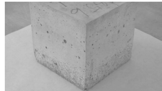
Obr. 5 Porušení bočních stran vlivem vzlínání solného roztoku
