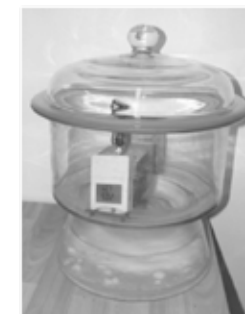
Obr. 4 Uspořádání zkoušky navlhavosti a vysychavosti
