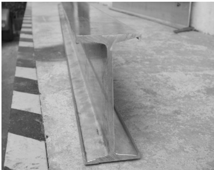
Obr. 9 - Etalon délky 4,5 m pro kalibrace přímosti měřící dráhy snímače (lehká slitina, frézováno, kalibrováno ČMI) .
