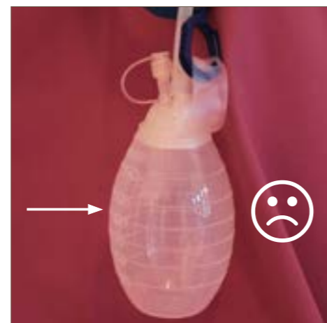
Vakuumflasche ausgedehnt (mit Luft): • Sog nicht ausreichend
