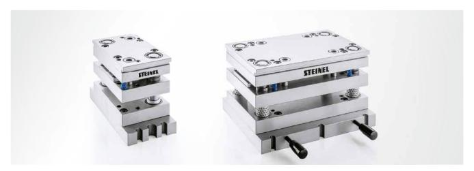
Die Werkzeugmodule sind in zwei Breiten (200 und 250 mm) und sechs Längen (100 bis 350 mm) ab Lager verfügbar. Abhängig von ihrer Größe sind die Module mit zwei oder vier Kugelführungen ausgestattet.
