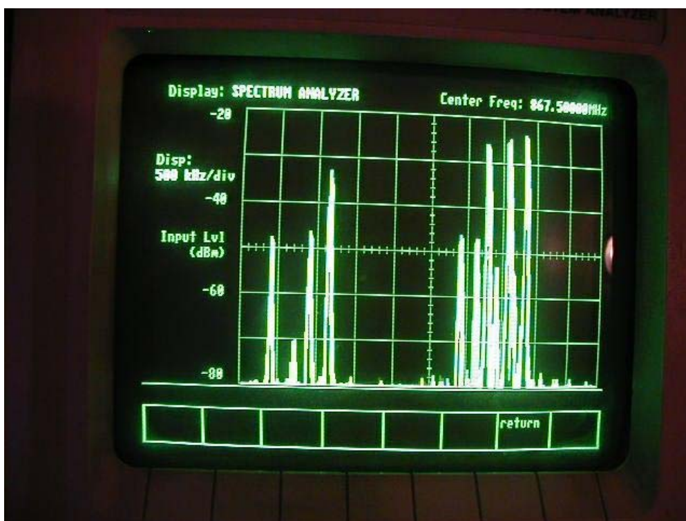
Figura N° 16 Portadoras estación repetidora en cerro San Cristóbal
