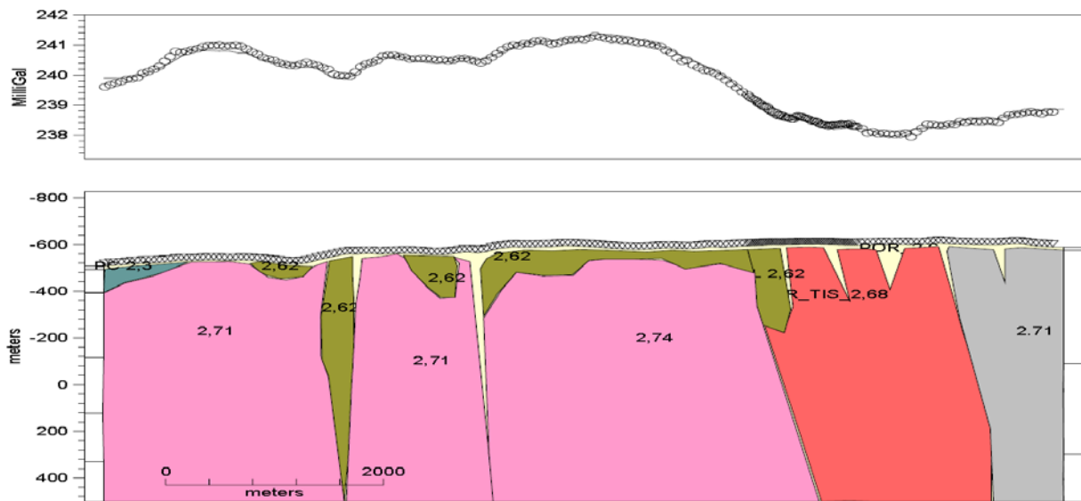
Obr. 9 Varianta A) Hustotní model prostředí pro naměřenou křivku ÚBA, profil CER-01Avib, úsek st -400 až 8000
