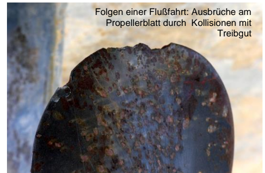
Blankes Aluminium! Der Schutzanstrich löst sich in Wohlgefallen auf
