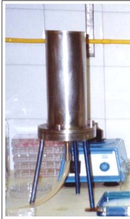
Figura 1.2.4.2. Portafiltres i embut de 90 mm de diàmetre per a l'aplicació del mètode Viraden.
