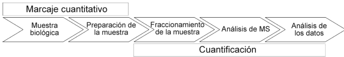
Figura 2. El diseño experimental en un ensayo proteómico normalmente pasa por cuatro fases: la preparación de la muestra, el fraccionamiento de la misma, su análisis por espectrometría de masas (MS) y el análisis de los datos obtenidos. En la proteómica cuantitativa, la abundancia de las proteínas puede ser medida durante el fraccionamiento de la muestra (proteómica cuantitativa basada en la electroforesis bidimensional) o durante el análisis de MS (proteómica cuantitativa basada en la espectrometría de masas). Adaptado de [23].
