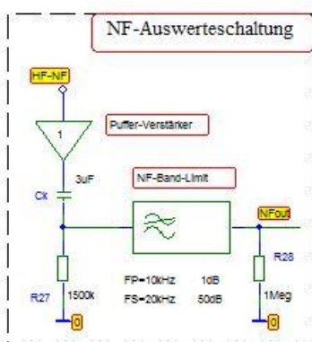
Abb. 36 Auswerteschaltung für den Audion- Anodenstrom
