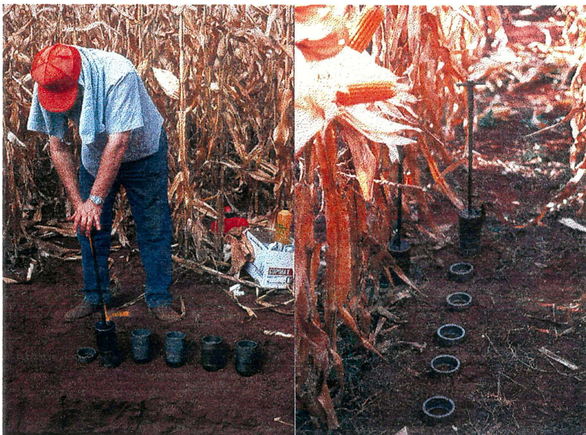
Figuras 4 e 5 Processo de retirada das amostras indeformadas de perfis de solos descritos para cada sistema de cultivo e manejo.
