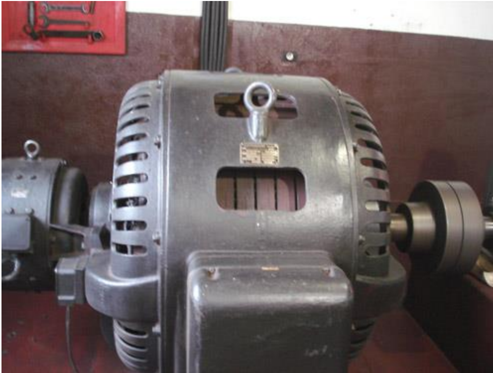
Figura 15 – Exemplo de gerador síncrono. Fonte: CERPCH
