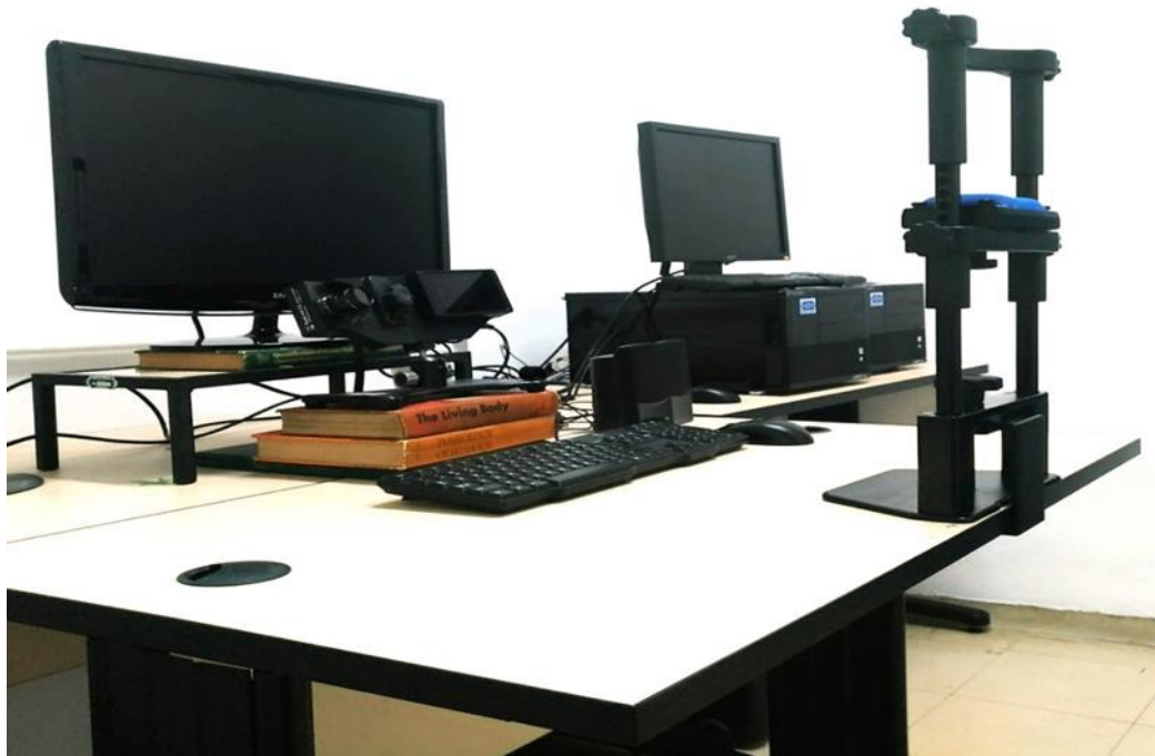
Figura 1. Eyelink 1000® Desktop Mount: monitor LCD, câmera, fonte de iluminação infravermelha, teclado e suporte para cabeça, em primeiro plano. Ao fundo, computadores Intel Core 2 Quad, Intel Core 2 Duo e monitor LCD utilizado para calibragem.
