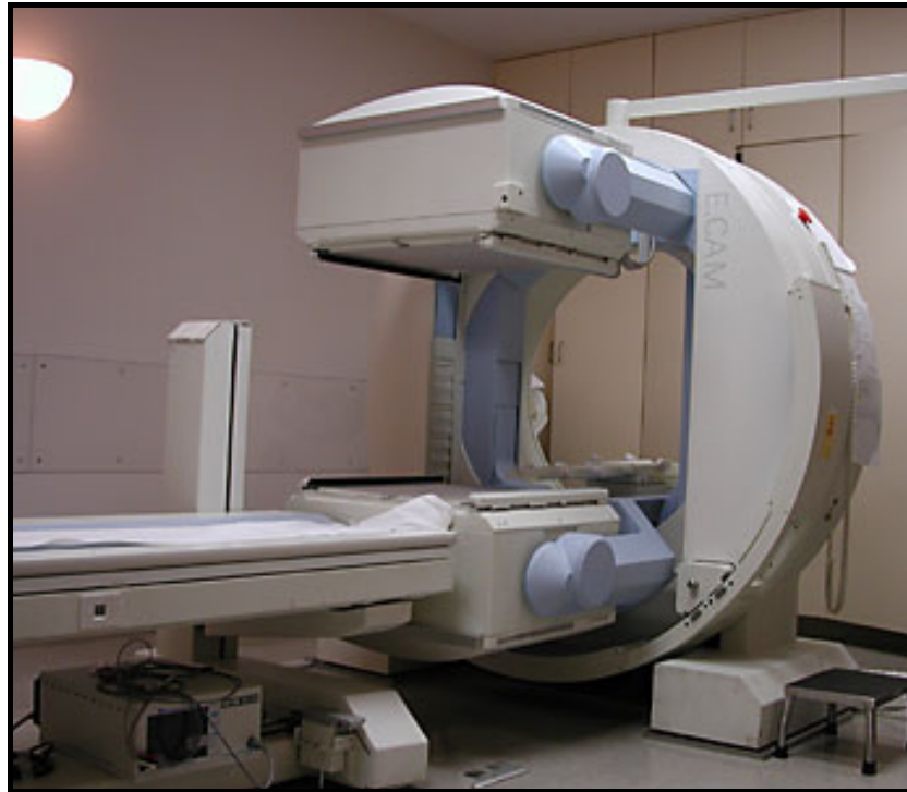
FIGURA 3 – Equipamento de Tomografia por Emissão de Fóton Único – SPECT (Dual Head-E.CAM/ Siemens) [10] .
