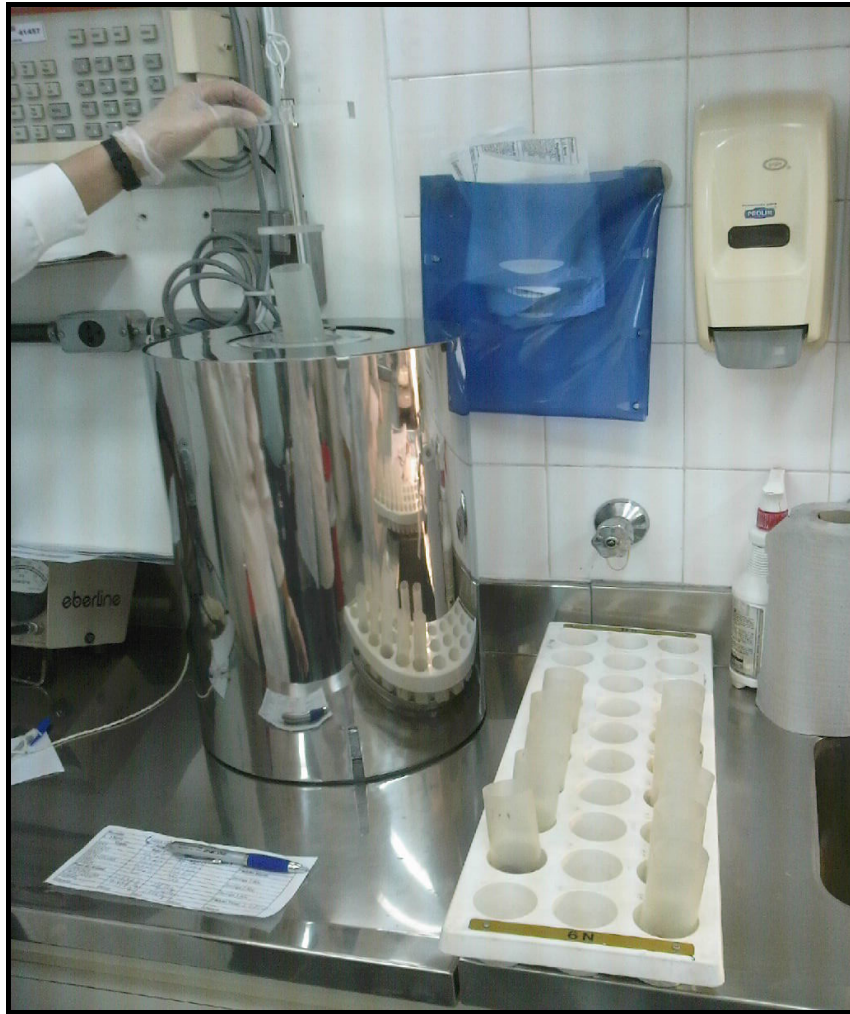
FIGURA 15 - Calibrador de dose (Capintec) utilizado para medir a atividade dos órgãos dos ratos.
