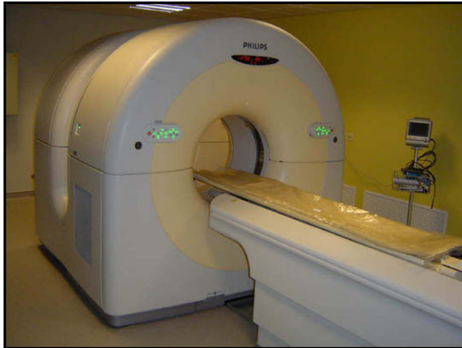
FIGURA 2 – Equipamento de Tomografia por Emissão de Póstron – PET/CT (Gemini/Philips) [9] .
