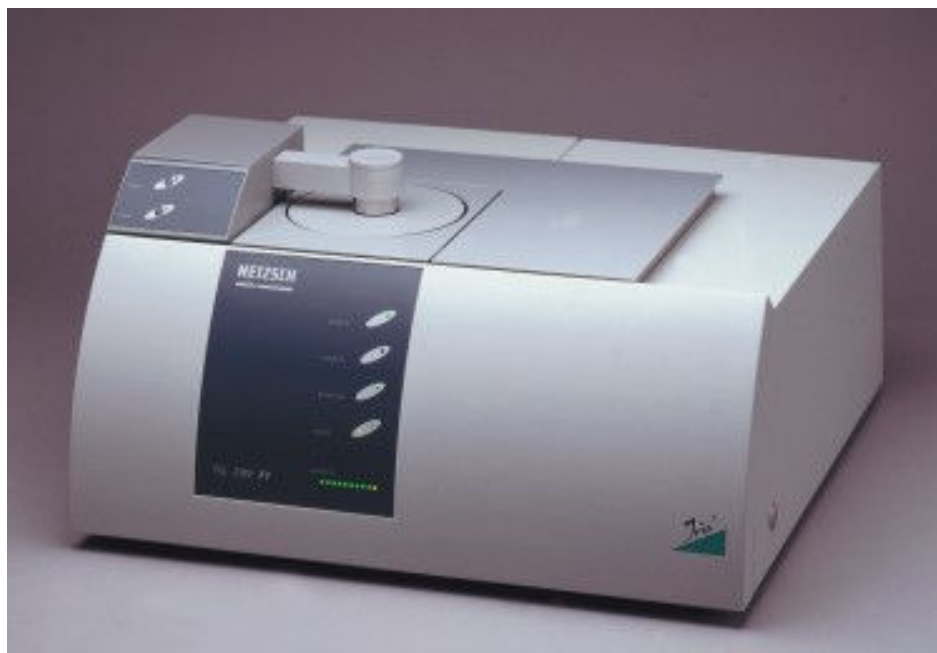
Figura 10 – TG 209 F1 Iris da Netzsch.
