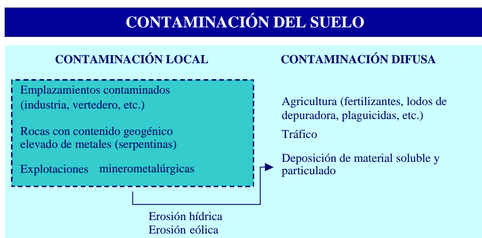
Figura 2.1.- Contaminación local y difusa del suelo. Fuente: AEMA, 2002.
