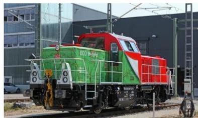
Abbildung 1: Rangierlokomotive H3 von Alstom
