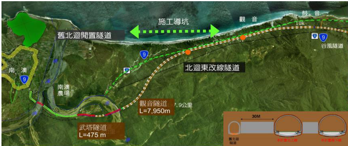
以台鐵舊北迴開置隧道為施工導坑
