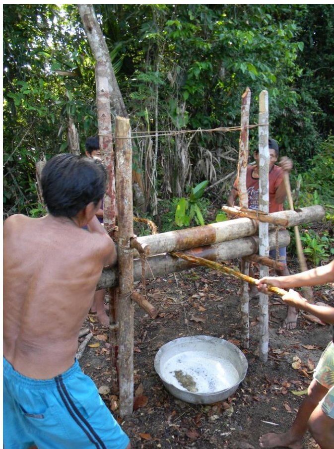
Image 54 - Extraction de jus de canne à sucre avec un moulin
