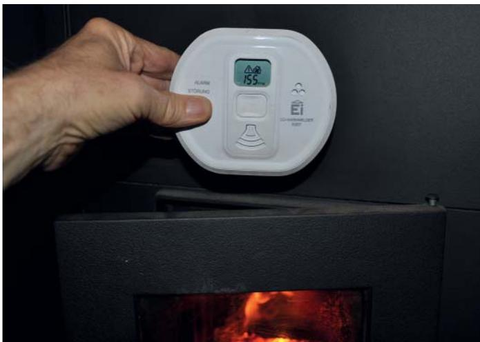
► **Abb. 3** Beim Anfeuern lassen sich an der offenen Ofentür mit einem handelsüblichen CO-Warngerät kurzzeitig deutlich erhöhte CO-Konzentrationen nachweisen.
