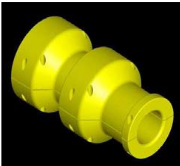
Рисунок 5.6 – Конфигурация элемента ограничителя изгиба
