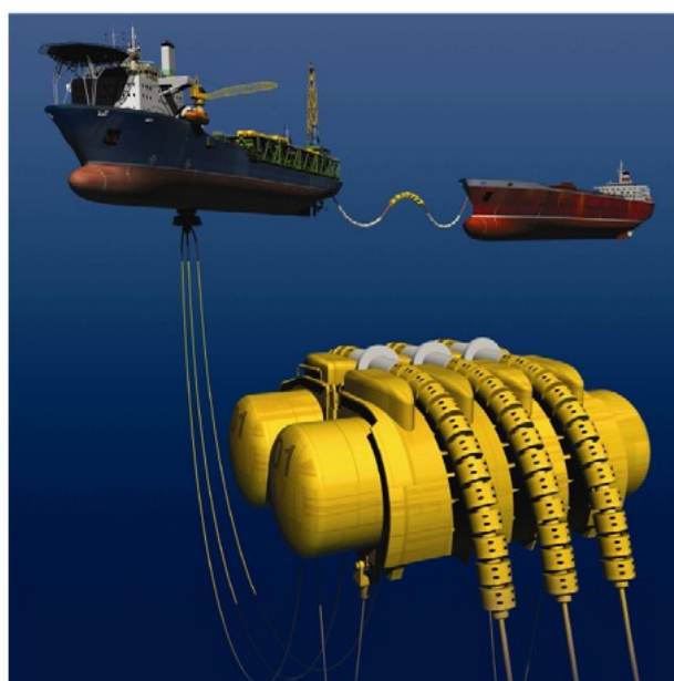
Рисунок 5.19 – Буй подводный с емкостями плавучести, с желобами
