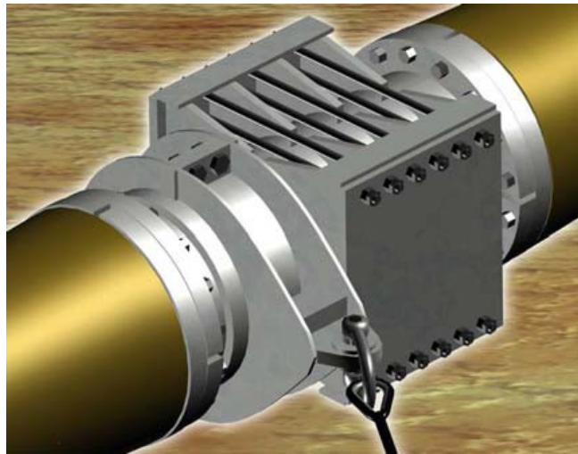
Рисунок 5.24 – Общий вид сборки хомута каната
