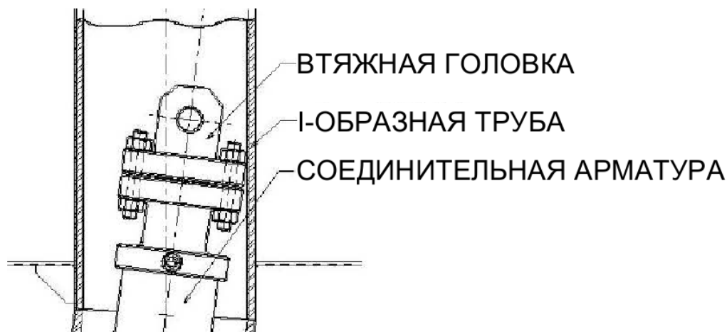
Рисунок 19.1 – Втягивающая головка, втягиваемая через I-образную трубу
