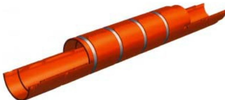
Рисунок 5.42 – Защита механическая гибкого трубопровода. План общий
