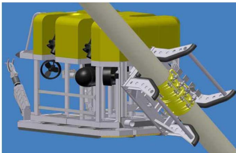
Рисунок 17.3 – Установка хомута ремонтного большого
