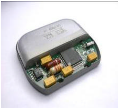
图 1 植入式电刺激器的专用电路、电池和钛外壳装配
