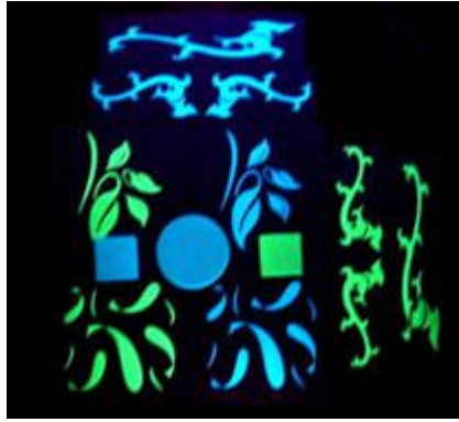
附图 1 多功能陶瓷涂层夜晚的发光照片
