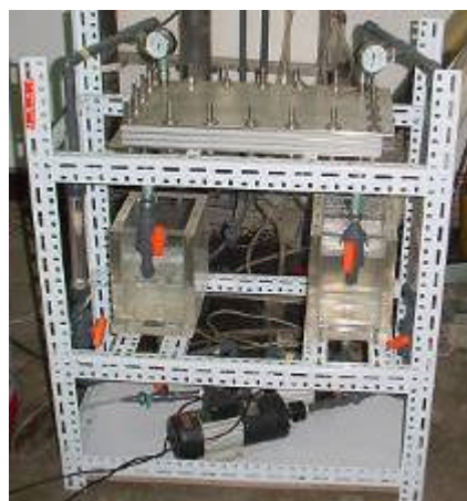
图3 极板面积 300 \times 500 的液流电池实验电堆
