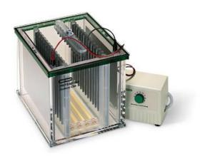
Equipo de Electroforesis Bidimensional: Protean Plus Dodeca Cell (Bio-Rad)
