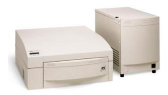
Escáner de Fluorescencia: FX ProPlus (Bio-Rad)
