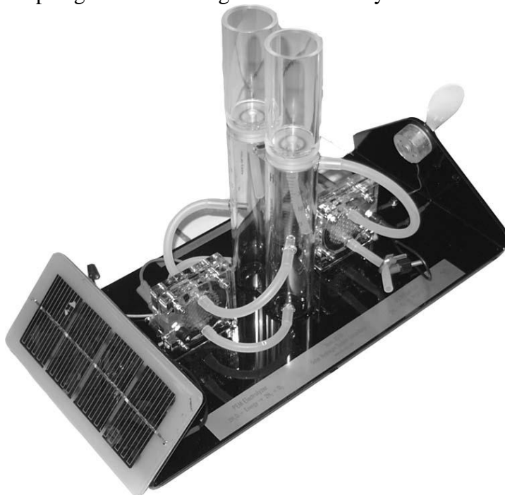
Figur 1: Solcelle, elektrolysecelle, gasslager og brenselcelle montert sammen.
