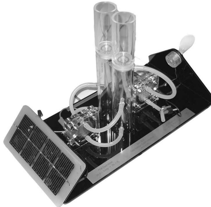
Figur 1: Solcelle, elektrolysecelle, gasslager og brenselcelle montert sammen.
