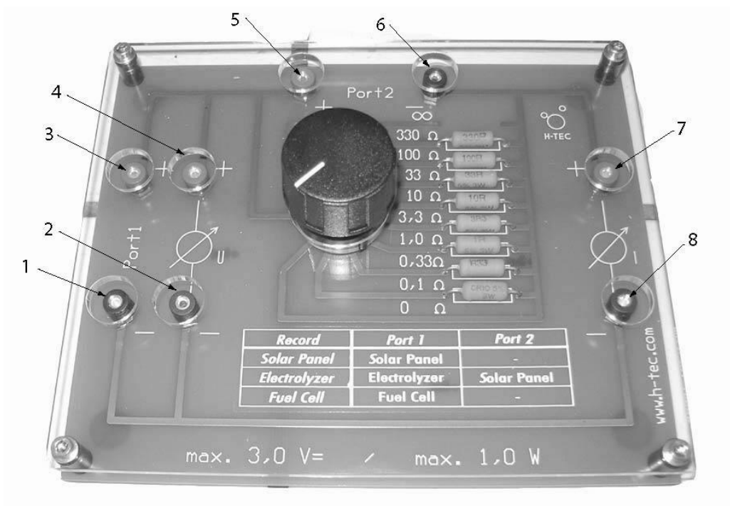
Figur 2: Dekademotstand med tilkoblinger for spenningskilde og måleinstrumenter.
