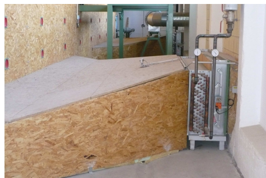
Abb. 78 Wärmetauscher und Zuluftkubus für den Bandrockner
