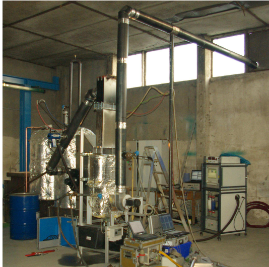
Abb. 62 Versuchsaufbau des elektrostatischen Nassabscheiders
