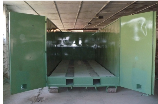
Abb. 91 Einbauten Container (Luftführung)
