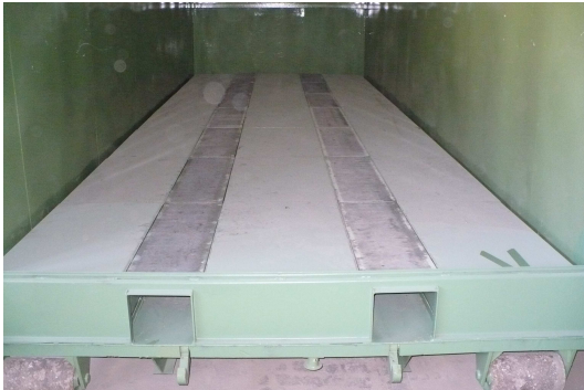
Abb. 92 Einbauten Container (Luftführung)
