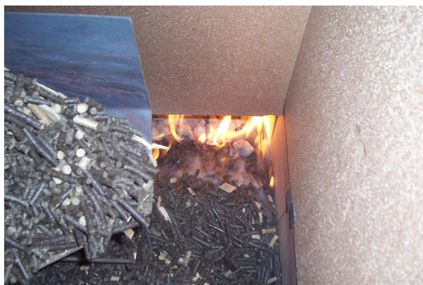
Abb. 57 Brennstoffeinschub und Feuerraum – Verbrennungsversuch Gärrest 8 mm
