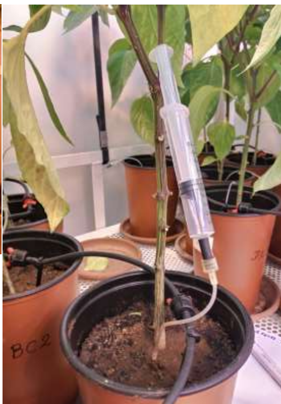
Figura 02: Sondas Ryzon colocados en cada macetero para extracción del agua capilar.
