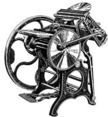
Fig. 38 Minerva (Hacia 1870) Prensa de pedal en la que la presión se ejerce de modo horizontal (prensa horizontal) y el sistema de entintado ya es automático.
