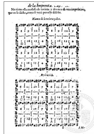
Fig. 53 Imposicion a 32 (Procedencia y autorización: BHUV Var.388[1])
